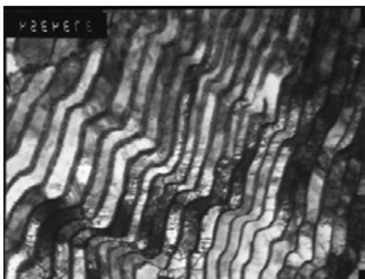
Рис. 1. Структура стали марки 80P после МТО 360 °С/19 600 Н (светлопольное изображение, увеличение 37 000)
