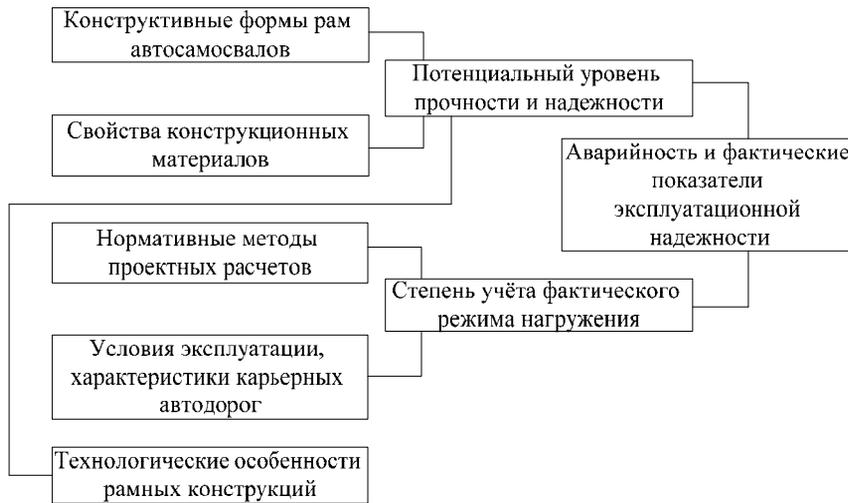
Рис. 1. Причинно-следственный комплекс формирования аварий и показателей надежности рам автосамосвалов
