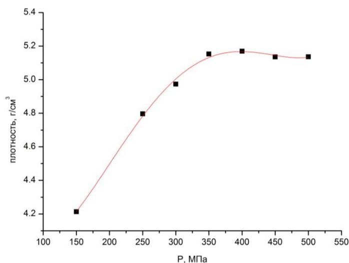
Рисунок – 1 Кривая уплотнения образца состава  $99\%SnO_2-1\%Fe_2O_3$ , полученного методом соосаждения
