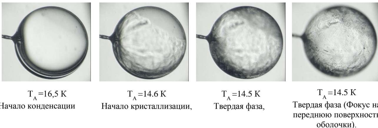
Рис.6 –Замораживание смеси  $\text{H}_2\text{-D}_2$  в оболочке
