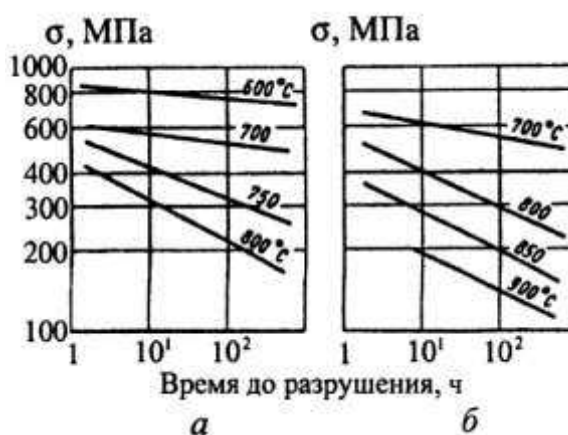
Рисунок 1.7 – Длительная прочность жаропрочных никелевых сплавов: а – сплав ХН77ТЮР; б – сплав ХН70ВМТЮ
