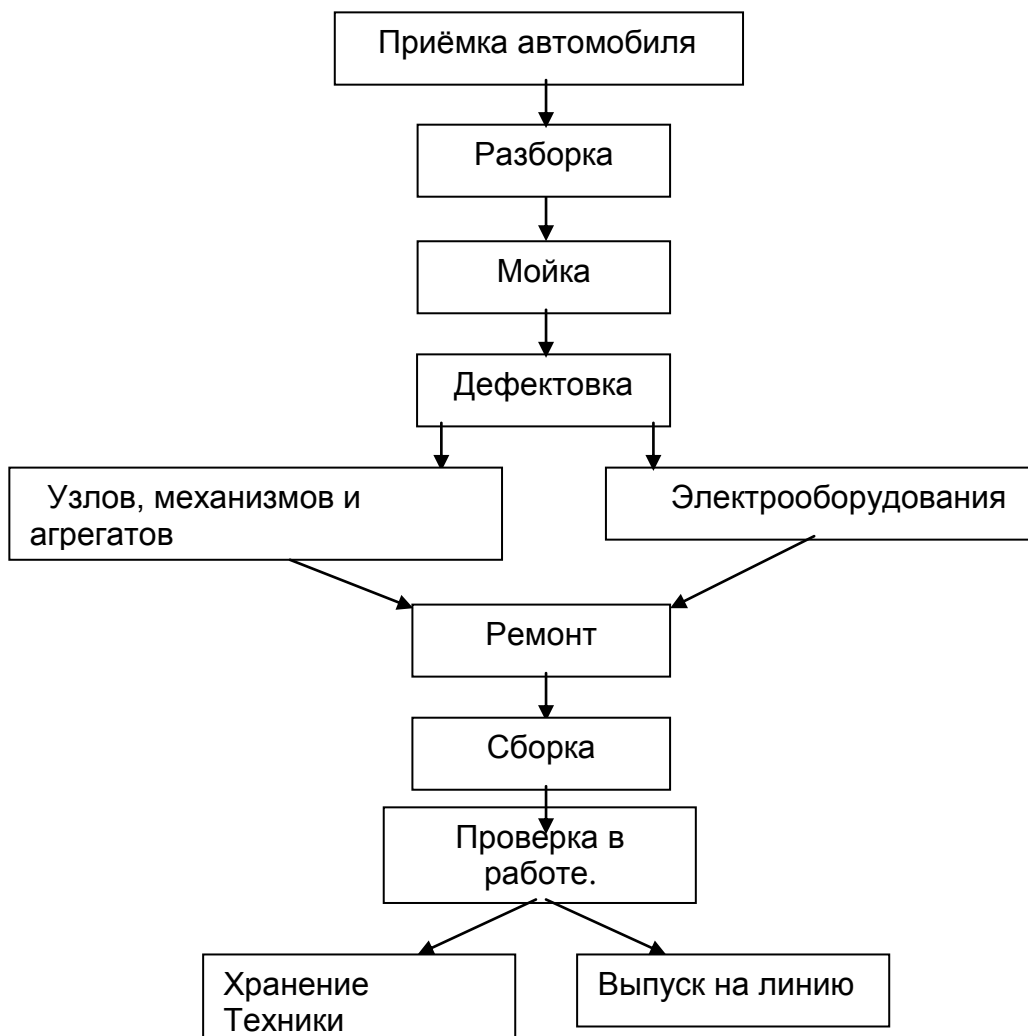
Рисунок 1.1 – Схема существующего технологического процесса
