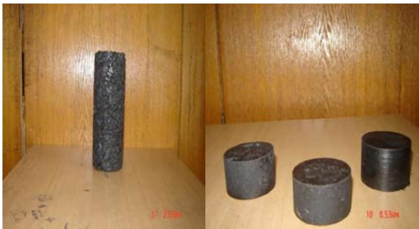
Рис. 3. Образцы подштыревых пробок с добавкой измельченного алюминия
