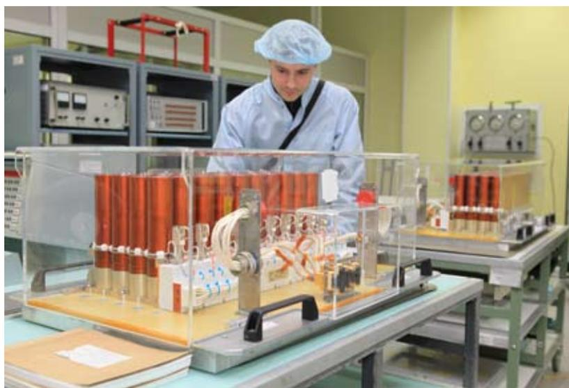
Рис. 8. Входной контроль литий-ионных аккумуляторных батарей компании Saft
