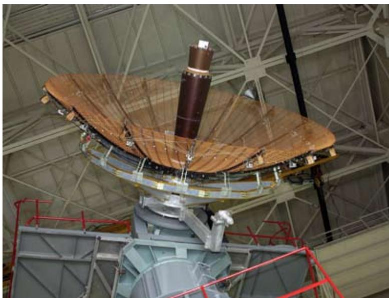
Рис. 5. Антенна с рефлектором из золочёного сетеполотна
