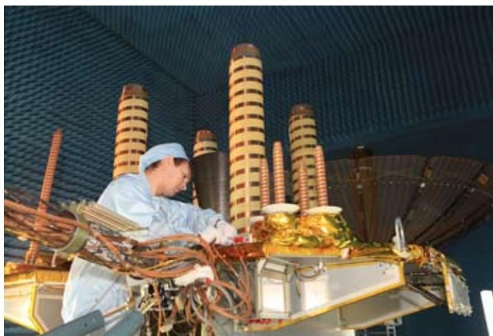
Рис. 6. Высокочастотные испытания целевой аппаратуры КА «Луч-5А»
