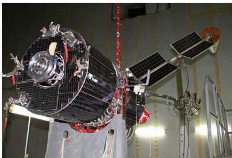
Рис. 3. Спутник персональной связи «Гонец-М» на высокочастотных испытаниях
