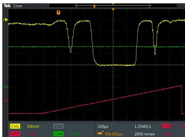
Рис. 5. Осциллограмма сигнала с цилиндра Фарадея, когда ширина измерительной щели больше диаметра профиля пучка по его основанию (жёлтый трек – сигнал с цилиндра Фарадея, малиновый – импульс модуляции тока сканирующей линзы)
