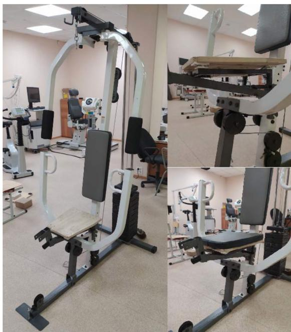
Рис. 2. Прототип стабилиметрической платформы, интегрированной в конструкцию силового тренажера
