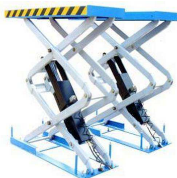
Рисунок 3.12 – Основные виды подъемников: 1 – двухстоечный; 2 – четырехстоечный; 3 – ножничные; 4 – плунжерные
