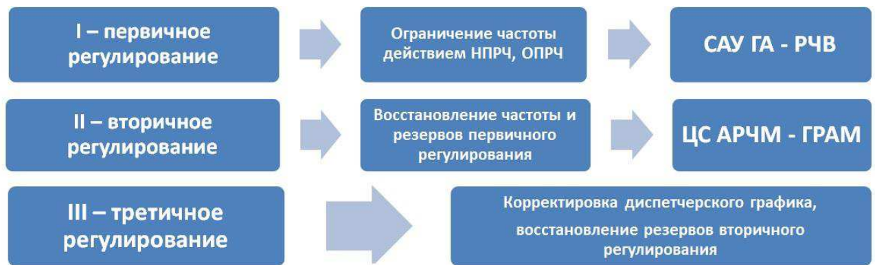
Рисунок 15 – Последовательность процесса регулирования частоты в энергосистеме
