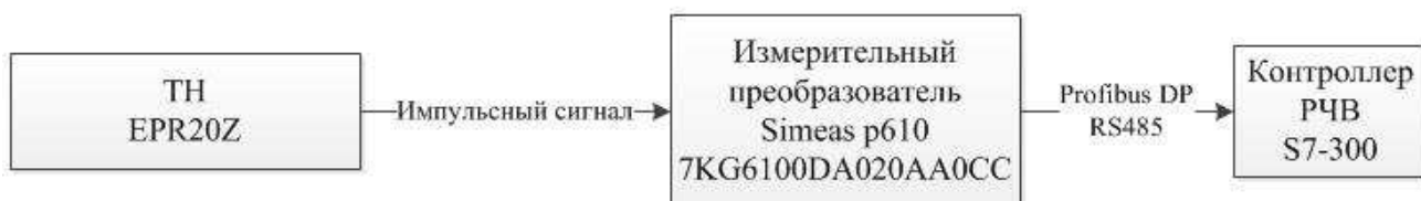
Рисунок 22– Схема подключения канала измерения ТН Зейской ГЭС
