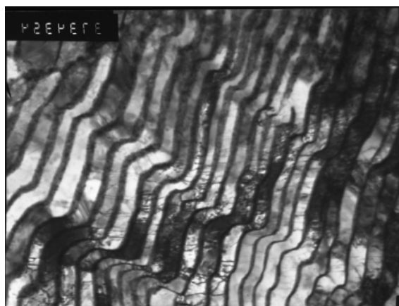
Рис. 1. Структура стали марки 80Р после МТО 360 °С/19 600 Н (светлопольное изображение, увеличение 37 000)
