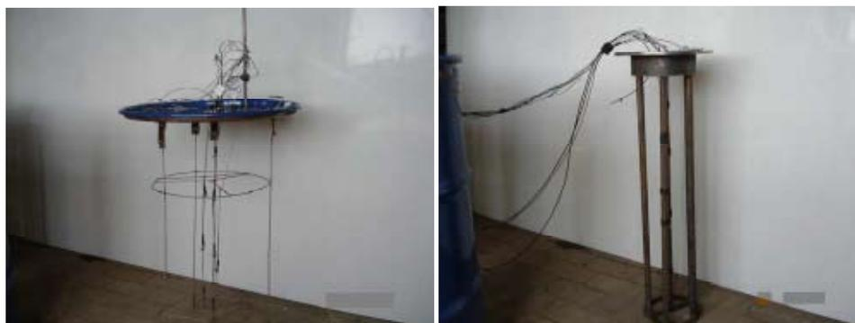
Рис. 10. Блок датчиков экспериментальной установки для измерения температуры во внутреннем объеме бочки
