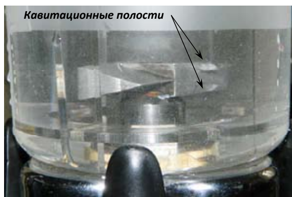
Рис. 4. Место локализации начальной стадии кавитации на движущейся лопасти
