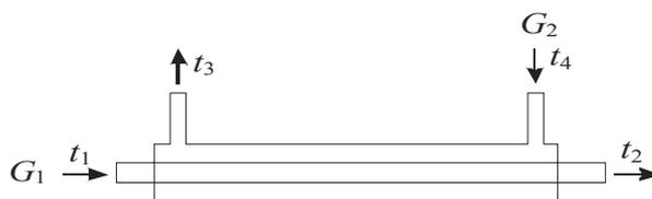
Рис. 2. Схема прямоточного теплообменника
