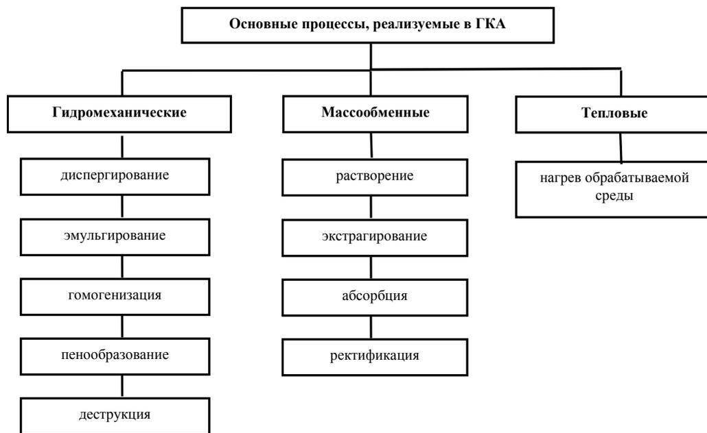
Рис. 16. Схема классификации технологических процессов, реализуемых в ГКА
